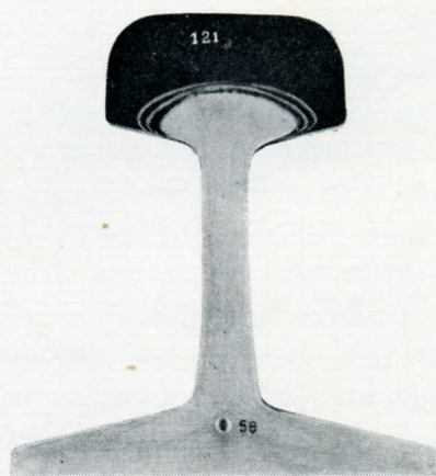
Fig. 97. Ætset Tværnsnit af Dobbeltstaalskinne. Det mørke Parti viser det slidfaste Specialstaa.
