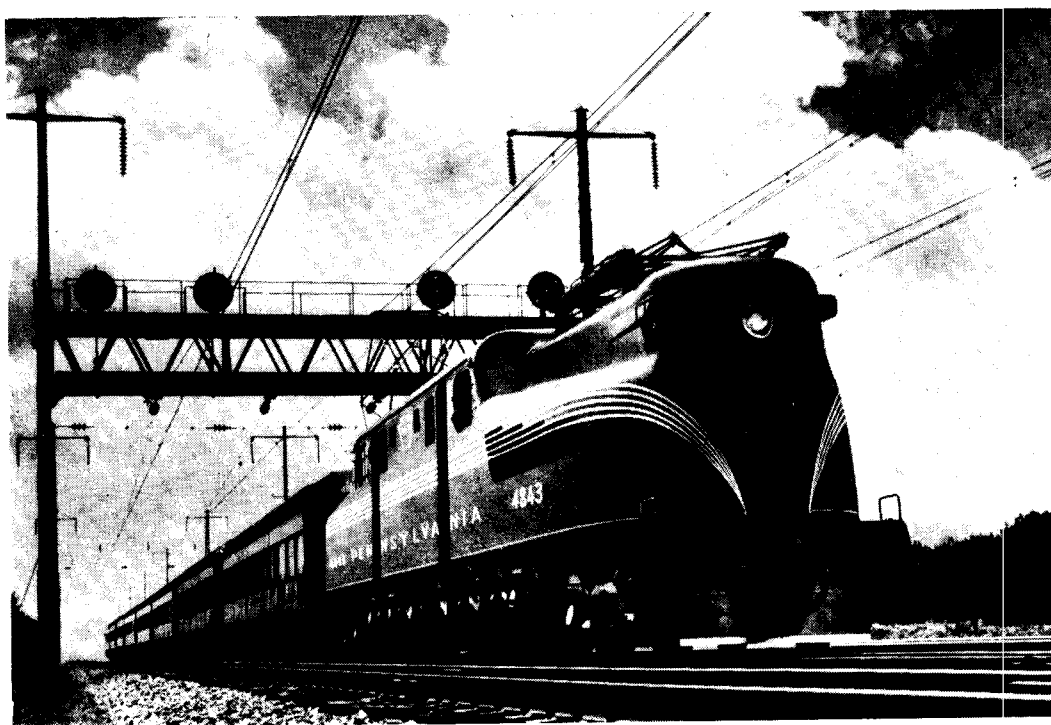
Fig. 1. Moderne amerikansk diesellokomotiv. På signalbroen ses daglyssignaler, hvor den indbyrdes stilling af tre hvide lys giver de enkelte signalbilleder.
