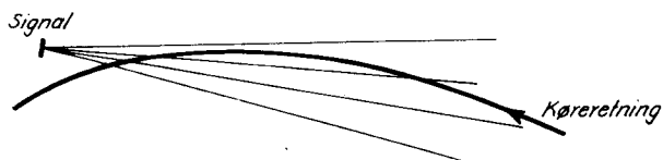
Fig. 1: Spredelinse skal anvendes, dersom kurveradius er mindre end 1500 m.
