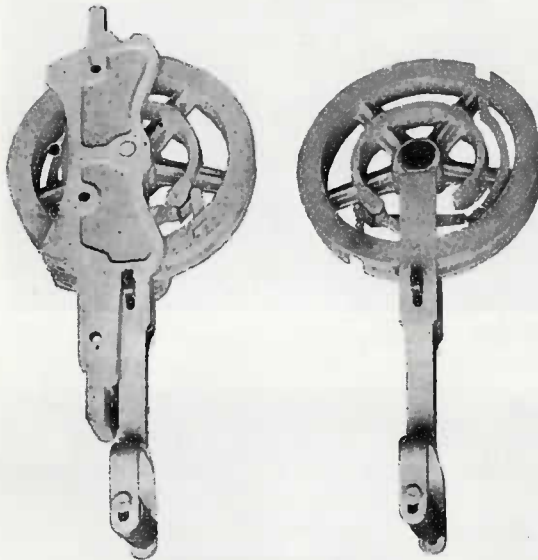
Fig. 83. To-Stillingshaandtag (Laasehaandtag), gl. Type. (Siemens & Halske).
