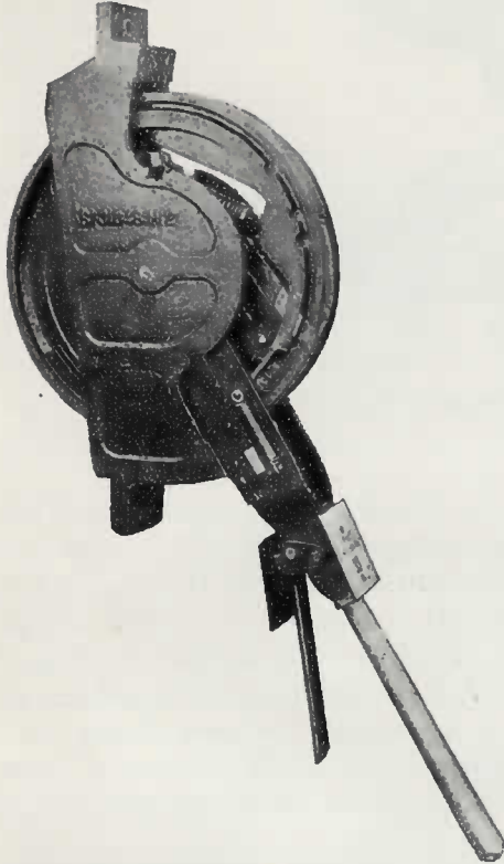
Fig. 85. Sporskiftebetjeningshaandtag med to Omstillingsskiver og Opskæringsindretning samt Traadbrudskontrol (Siemens & Halske).
