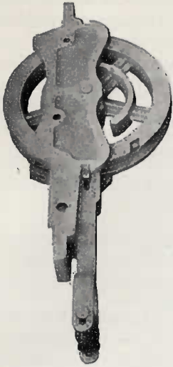
Fig. 88. Signalhaandtag (To-Stillings). Siemens & Halskes ældre Type.
