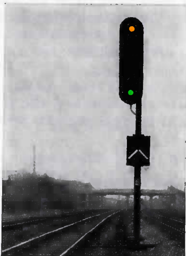
Et brændgult, fast lys lodret over et grønt, fast lys.
