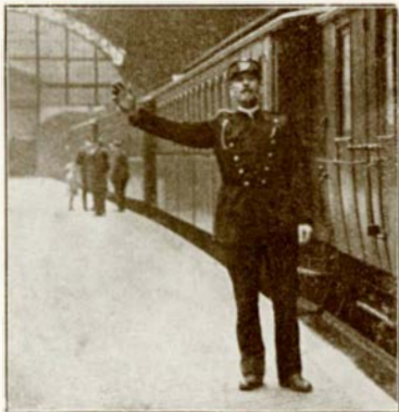
Togføreren gør Front mod Lokomotivet og ud- strækker d e n e A r m v a n d r e t .
