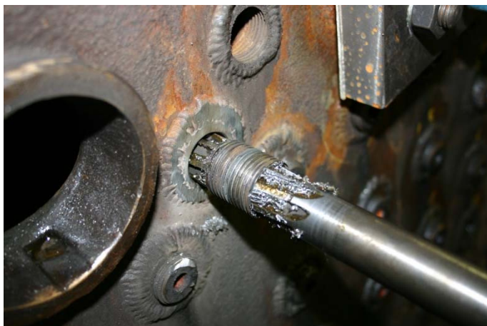
Gevindet skæres op og det sidste stykke af støttebolten lader sig skrue med ud og sidder i skæret på tappen.
