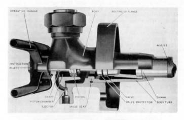
Fig. 18.—Diamond Soot Blower: Valve Open.
