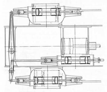
FIG. 94.—THE GRESLEY VALVE GEAR IN PLAN.
