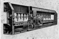
HYDRAULIC BOILER SHELL BENDER
